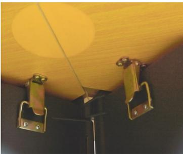
3. Klappen Sie die Tischplatte auseinander und legen Sie diese mit der Nut auf den Thekenkoffer. Befestigen Sie die Tischplatte mithilfe der Scharniere.
