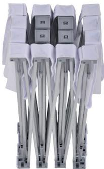
2. Fassen Sie das Scherengitter mittig an seinen Verbindungspunkten und ziehen es vorsichtig auseinander. Schieben Sie nun die sich gegenüberliegenden Knotenpunkte ineinander bis die Klick-Verschlüsse einrasten. Lassen Sie das Gitter vorerst auf dem Boden liegen.
